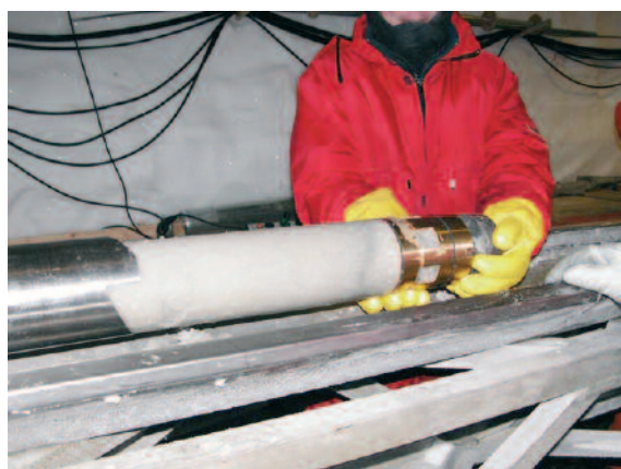
Iskerneboringerne i Grønland - Borets chipskammer og pumpe fuld af slush under rensning af borehullet
